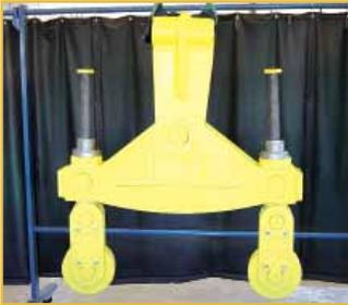
Ausgleichsschwinge für die Verspannung von Förderbändern im Tagebau mit einzeln einstellbaren Umlenkrollen.
