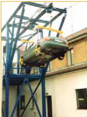
Stahlgerüst mit Doppelwinde, Traversen und Sonderaufnahmen für Kfz.
