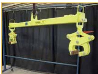
Traverse mit verstellbaren Sondergreifern und Oberflächenschutz zum Heben von Flugzeugturbinen.
