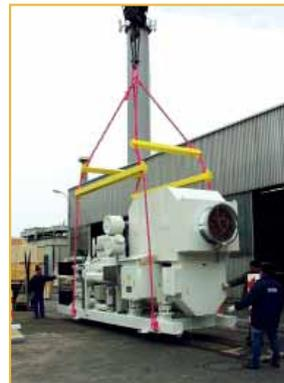
Spreizensystem mit 4-Strang-Ketten und Verkürzern für einen Generator mit asymmetrischem Schwerpunkt
