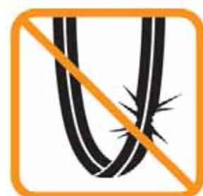
Beschädigte Rundschlingen und Hebebänder ablegen und ersetzen.
