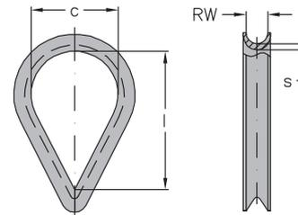
Das Maß c entspricht dem Bolzen-Ø.
