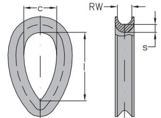
Das Maß c entspricht dem Bolzendurchmesser.
