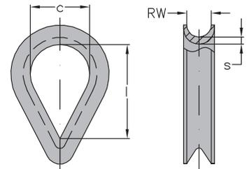
Das Maß c entspricht dem Bolzendurchmesser.
